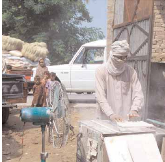
Устройство для резки асбеста в городе Мардан (Пакистан) на главной дороге в жилом районе. Асбестовая пыль разлетается повсеместно. Вентилятор, предназначение которого не совсем понятно, не работает
